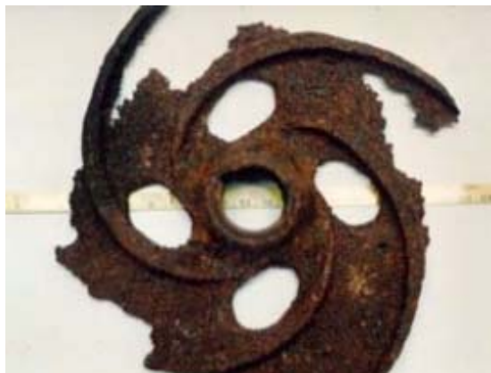
Fig. 1- Rotor danificado pela cavitação em uma bomba de água.
